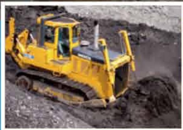
适于各种操作条件和作业需求的推铲也适合需要路边弃土和泥土铲运的推土作业
